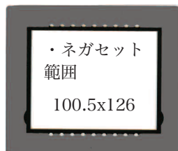
図22 スポンジ上の フィルムガイド (黒塩ビ厚約0.3mm)
