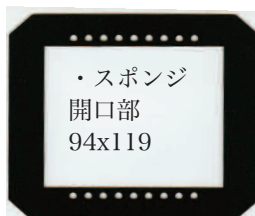
図22 スポンジ上の フィルムガイド (黒塩ビ厚約0.3mm)
