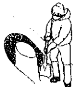
②さらにスコップ掘り、高さ70cm程度の円柱を作る
