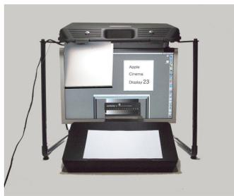
写真13 正刷り (反射原稿、刷り上がり) の全画像形態が同一照明条件で色判定と調整がおこなえるよう構成した。
